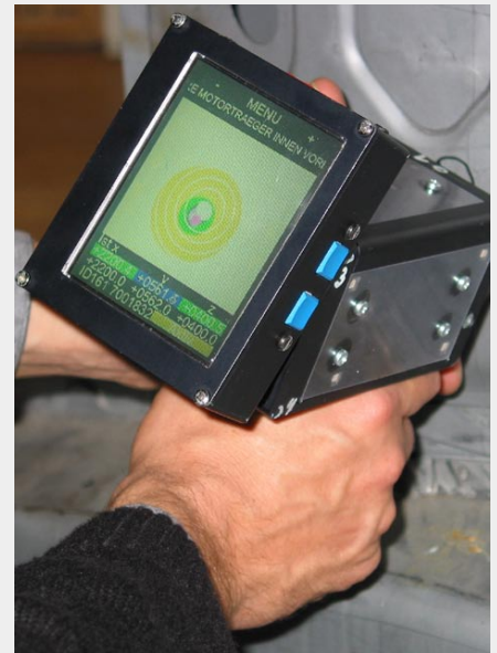
Das 3D-Bolzenschweißsystem im Einsatz - Nach erfolgreicher Positionierung mit Hilfe eines 3D-unterstützten Navigationsdisplays kann der Montagebolzen an der Rohkarosse verschweißt werden
